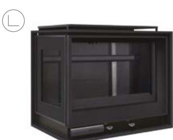
V 80 CORNER moc: 11 kW wydajność: 78% wymiały (SxWxG): 745 x 632 x 453 mm waga: 166 kg
