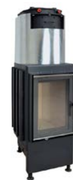
PG 1 W model z nakładką wodną moc: 10 kW wydajność: 86,1 % wymiary: 450x1430x675 mm waga: 260 kg ilość wody w nakładce wodnej: 17l
