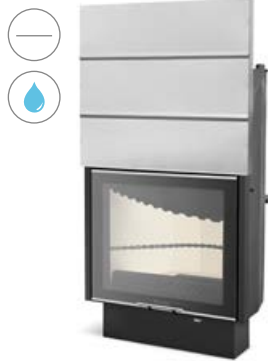
PL 210 ECO SP GILOTYNA moc: 14 kW / 19 kW sprawność: 75,2% wymiały (SxWxG): 1170 x 596 x 695 mm
