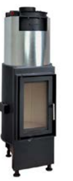
PG 2 W model z nakładką wodną moc: 12,6 kW wydajność: 85,7 % pojemność wody 15 L wymiary: 465x1500x520 mm waga: 210 kg
